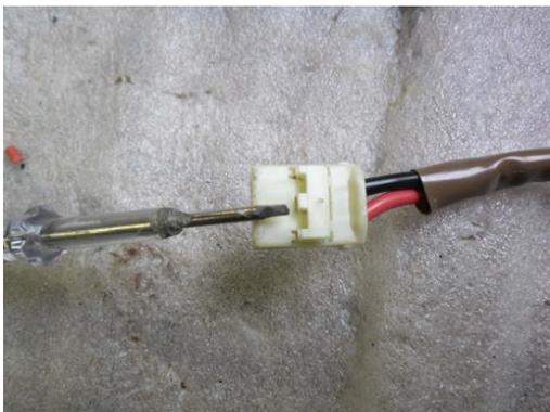
Sobald der Stecker entfernt ist, heben Sie den Clip im Gehäuse mit einem Schraubendreher an, um ihn zu entriegeln.
