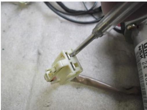
Drücken Sie den Clip im Inneren des Gehäuses mit einem kleinen Schraubendreher zurück. Ziehen Sie gleichzeitig den Stecker aus dem Gehäuse.
