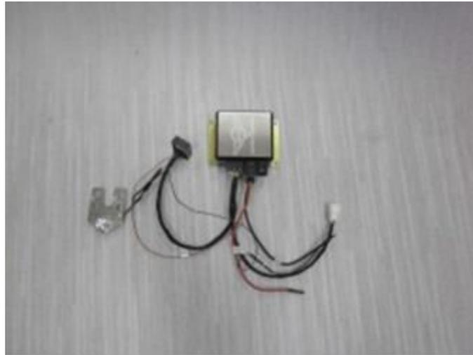
1. Verbinden Sie den Kabelbaum mit der Servolenkungs-ECU.
