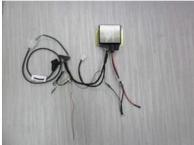
1. Connectez le faisceau de câbles à l'ECU de la direction assistée.
