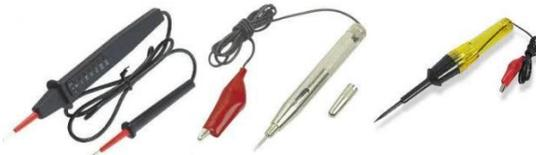
Se ligar a ignição e rodar o potenciómetro (reóstato) no sentido contrário ao dos ponteiros do relógio (para a esquerda) para um apoio máximo, agora pode medir entre o solo/terra do carro e o fio azul do controlador. Deve haver uma luz intermitente visível. Se rodar o potenciómetro para a direita, a velocidade de intermitência irá aumentar.
